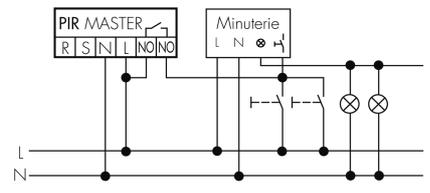
**Betrieb mit Drehschalter «Hand - 0 - Automat»**
