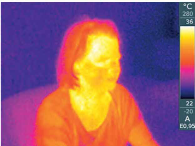
Fig. 2: Un capteur infrarouge passif (PIR) enregistre les images thermiques qui se modifient rapidement dans sa zone de détection. Visible sur cet enregistrement infrarouge d'un buste humain, un net contraste entre la radiation thermique d'une personne et son environnement existe généralement.
