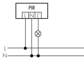
**Fonctionnement normal avec circuit RC**
