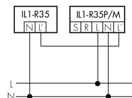
**Fonctionnement en combinaison avec un interrupteur quelconque**
