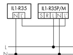
**Fonctionnement en combinaison avec un interrupteur quelconque**
