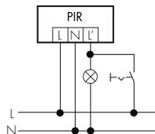
**Fonctionnement avec interrupteur rotatif «Manuel - 0 - Automatique»**
