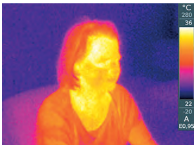
Fig. 2: Un sensore a raggi infrarossi passivo (PIR) registra le mappe termiche in rapido divenire nella propria zona di rilevamento. Quando è visibile l'immagine a infrarossi di un busto umano, si nota un netto contrasto tra la radiazione termica della persona e l'ambiente circostante.
