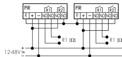
**Funzionamento Master-Slave (Master in funzionamento Slave)**
