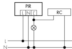
**Funzione con commutatore rotativo «Manuale - 0 - Automatico»**
