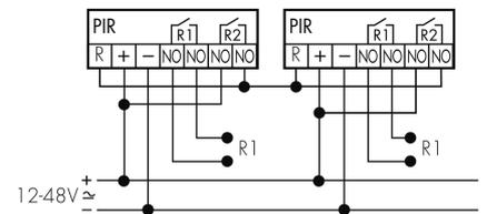
**Funzionamento Master-Slave (Master in funzionamento Slave)**
