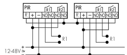
**Funzionamento Master-Slave (Master in funzionamento Slave)**
