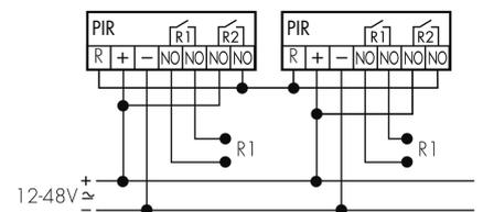
**Funzionamento Master-Slave (Master in funzionamento Slave)**
