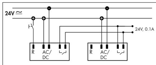
Wir empfehlen, nicht mehr als 5 Bewegungsmelder parallel zu schalten. Bei grösserer Anzahl können z.B. durch die Grösse/Unübersichtlichkeit des Erfassungsbereiches vermehrt Fehlschaltungen auftreten. Die Nachlaufzeit sowie der Dämmerungswert muss bei jedem Gerät separat eingestellt werden.
