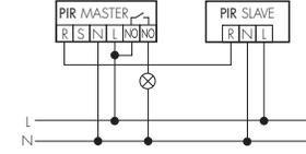
Vergrosserung des Bereiches mit einem bzw. mehreren Slave-Geräten. Achtung: Der Master muss immer an der dunkelsten Stelle montiert werden.
