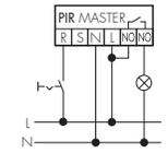
Ermöglicht das manuelle Einschalten der angeschlossenen Beleuchtung. Achtung: Licht muss wieder manuell ausgeschaltet werden.
