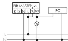
Bei Schaltung von netzparallelen Induktivitäten (Leuchtstofflampen, Schütze etc.) kann ein RC-Glied nötig sein.
