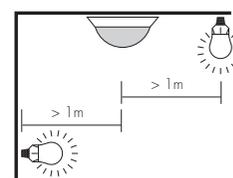
Distance minimum de l'éclairage allumé, de face ou latéral par rapport à l'appareil: 1 m
