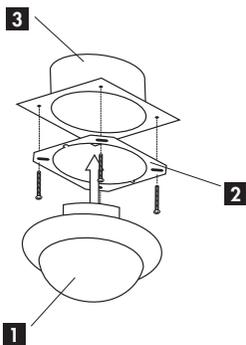
1. Capteur neutre pour montage encastré
