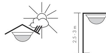
Monter si possible l'appareil dans un endroit protégé au mur à une hauteur de montage d'env. 2,5 à 3 m. Le champ doit être libre, car les rayons infrarouges ne traversent ni les objets opaques ni les vitres.
