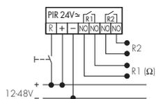
Une entrée Remote séparée (R) permet d'allumer resp. éteindre manuellement la lumière si besoin.
