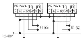
Division d'une grande zone de détection en différentes zones d'éclairage avec mesure individuelle de luminosité
