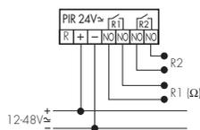
Commande de la lumière en fonction de la présence et de la luminosité ainsi qu'une commande CVC en fonction de la présence. La valeur de luminosité peut être sortie comme résistance variable au lieu du relais 1.
