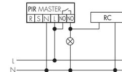
Per la commutazione con lampade fluorescenti, trasformatori, ecc. è eventualmente necessario l'uso di un circuito RC.
