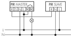
Aumento del campo d'azione con l'impiego di apparecchiature Slave. L'apparecchio Master deve essere sempre montato nella posizione in cui la luce del giorno è minima.
