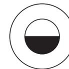
Maschera ad innesto per la copertura della zona di rilevamento a 180°
