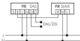
Aumento del campo d'azione con l'impiego di apparecchiature Slave.
