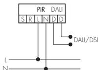
L'illuminazione viene regolata automaticamente in funzione della presenza e della luminosità.
