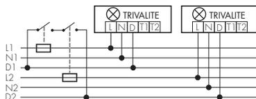
Per la comunicazione tra più lampade posizionate in gruppi fusibili diversi, si deve condurre il filo dati «D» attraverso un contatto ausiliario del rispettivo disgiuntore di potenza (LS). In questo modo viene garantito che, una volta disinserito il disgiuntore (LS), anche sul filo dati del gruppo non passi più corrente. In caso di utilizzo di un disgiuntore differenziale FLS/FI, anche il filo dati «D» va condotto attraverso il disgiuntore FLS/FI.
