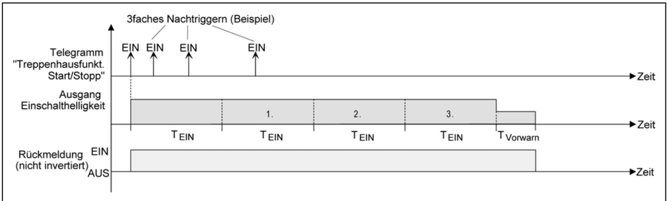
Durch diese Funktion kann die Beleuchtung in einem Treppenhaus – beispielsweise durch eine Person nach einem Einkauf - auf eine definierte Zeit verlängert werden, ohne wiederholte Male nach dem Ausschalten der Beleuchtung diese nachtriggern zu müssen.
