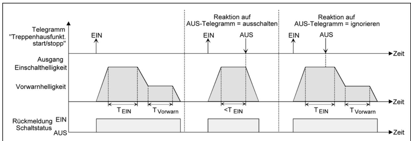
Der Parameter "Reaktion auf AUS-Telegramm" auf der Parameterseite "Kx - Treppenhausfunktion" (x = Nummer des Dimmkanals 1 ... 4) legt fest, ob die Treppenhauszeit ( $T_{\text{EIN}}$ ) der Treppenhausfunktion vorzeitig abgebrochen werden kann.
