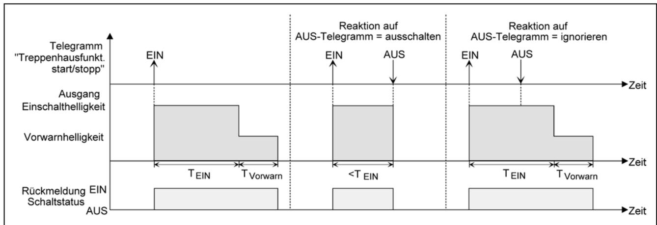
Zusätzlich kann das Ausschalten durch die Soft-Funktionen des Aktors beeinflusst werden. Unter Berücksichtigung einer Soft-EIN- und Soft-AUS-Funktion ergibt sich ein modifiziertes Ausschaltverhalten der Treppenhausfunktion.
