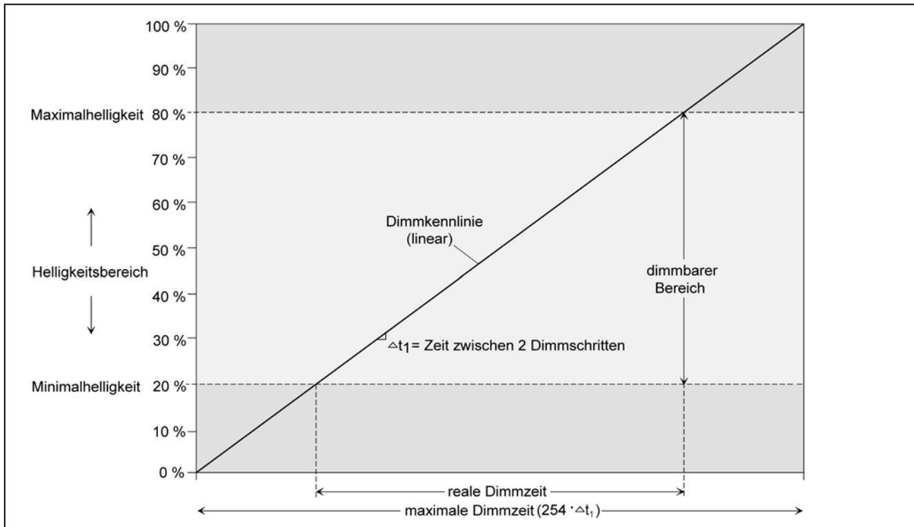
In einigen praktischen Anwendungsfällen ist eine lineare Dimmkennlinie nicht optimal. Deshalb ermöglicht der Aktor in der ETS alternativ eine benutzerdefinierte Anpassung des Dimmverlaufes. Dadurch können beispielsweise Helligkeitsveränderungen beim Dimmen an das subjektive Helligkeitsempfinden des menschlichen Auges angepasst werden, indem der Helligkeitsbereich in bis zu drei Teilbereiche mit unterschiedlichen Dimmschrittzzeiten aufgeteilt wird.
