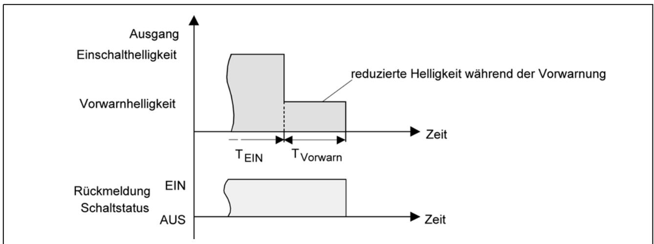
Die Vorwarnzeit beeinflusst die Werte der Rückmelde-Objekte, so dass erst nach dem Ablauf der Vorwarnzeit in den Rückmelde-Objekten der Schaltzustand "AUS" und der Wert "0" nachgeführt wird.
