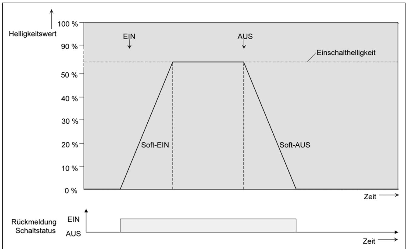
Die Dimmggeschwindigkeiten sind separat für die Soft-EIN- als auch für die Soft-AUS-Funktion in der ETS parametrierbar. Es wird direkt die relative Dimmschrittzeit zwischen 2 von 255 Dimmschritten parametrierbar.
