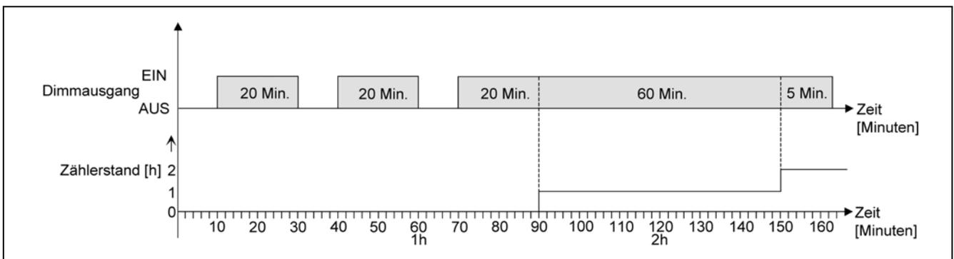
Die aufsummierten Betriebsstunden werden in einem 2 Byte Zähler nachgeführt und nichtflüchtig im Gerät gespeichert. Der aktuelle Zählerstand kann zyklisch oder bei Änderung um einen Intervallwert durch das Kommunikationsobjekt "Wert Betriebsstundenzähler" auf den Bus ausgesendet werden.
