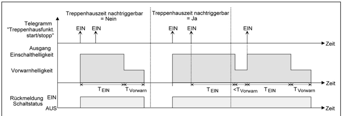
Zusätzlich kann das Einschalten durch die Soft-Funktionen des Aktors beeinflusst werden. Unter Berücksichtigung einer Soft-EIN- und Soft-AUS-Funktion ergibt sich ein modifiziertes Einschaltverhalten der Treppenhausfunktion.
