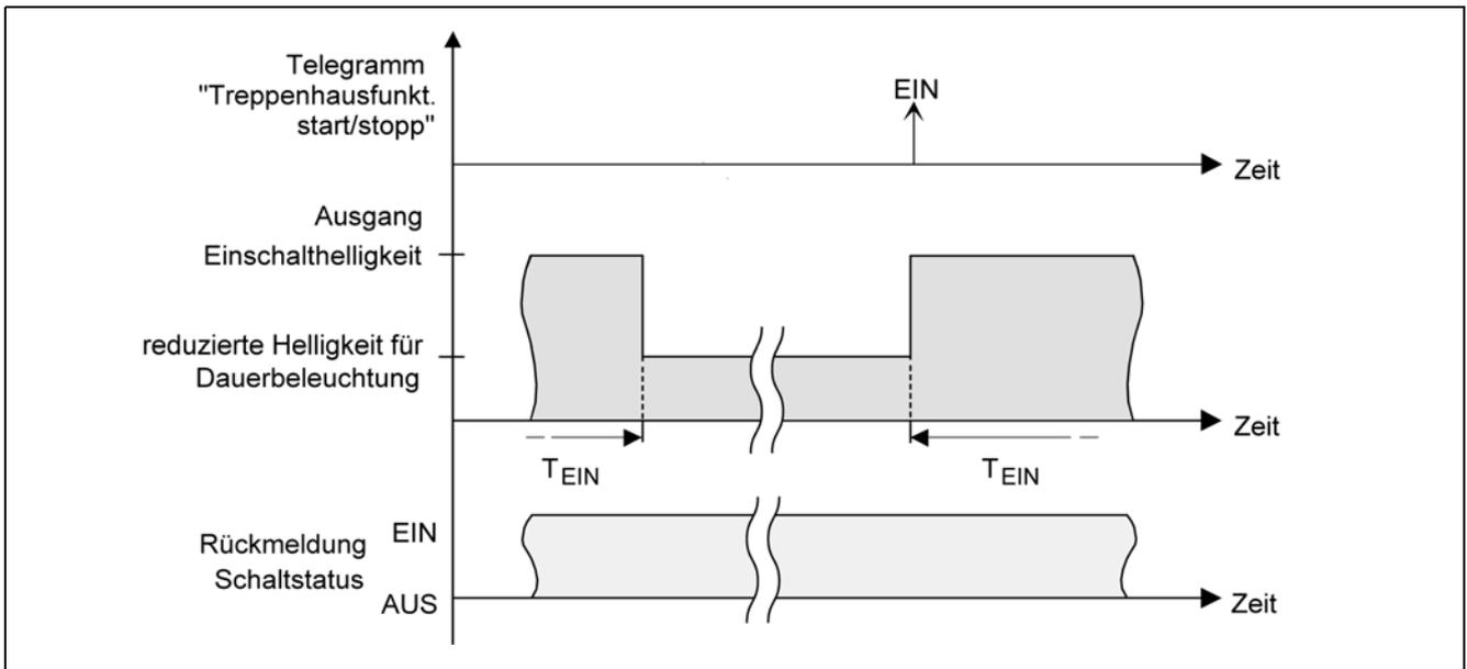
Die Dauerbeleuchtung bleibt nach Ablauf der Treppenhauszeit dauerhaft aktiv. Erst, wenn wieder ein EIN-Telegramm über das Objekt "Treppenhausfunktion start / stopp" empfangen wird, schaltet der Aktor zurück auf Einschalthelligkeit und zählt die Treppenhauszeit neu an. Der Empfang eines AUS-Telegramms über das Objekt "Treppenhausfunktion start / stopp" schaltet die Dauerbeleuchtung nur dann ab, wenn der Parameter "Reaktion auf AUS-Telegramm" auf "ausschalten" parametrier ist.
