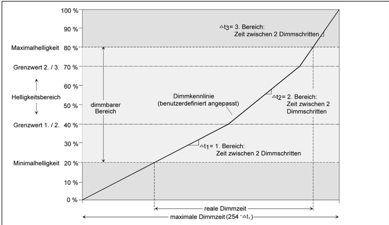
Als weitere Option ist es möglich, in der Kennlinienparametrierung vordefinierte Dimmkennlinien für Glühlampen oder für Halogenlampen einzustellen. Auf diese Weise kann der Dimmverlauf für die genannten Lampenlasten optimiert werden, ohne eine Dimmschrittzeit parametrieren zu müssen. In diesem Fall arbeitet der Dimmaktor mit fest implementierten Helligkeits-Teilbereichen und Dimmschrittzeiten.
