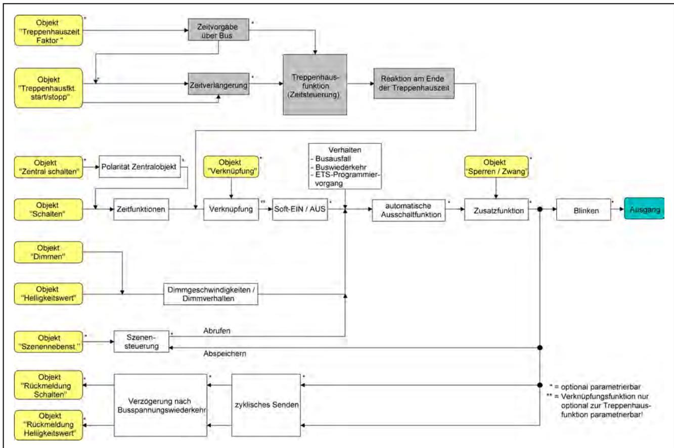
In Kombination mit einer Sperrfunktion ist auch eine zeitunabhängige Dauerlichtschaltung realisierbar, da die Sperrfunktion eine höhere Priorität besitzt und den Schaltzustand der Treppenhausfunktion übersteuert.
