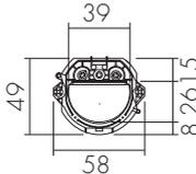
Die Abmessungen variieren geringfügig je nach bevorzugtem Schalterprogramm.
