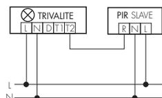
Nell'impostazione di fabbrica è possibile tramite contatto d'ingresso per pulsante T2, connettere un rilevatore slave di presenza di B.E.G., per l'ampliamento della zona di rilevamento.
