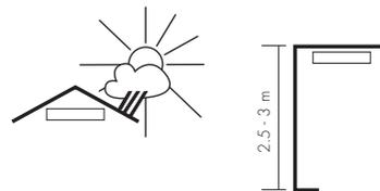
Se possibile, installare l'apparecchio in un luogo protetto alla parete a un'altezza di 2,5 fino a 3 m. È necessario fare attenzione al campo libero, poiché i raggi infrarossi non possono vedere attraverso oggetti solidi né attraverso i vetri.
