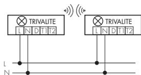
Per la comunicazione tra più lampade, in alternativa al filo dati, si può installare una rete di radiocomunicazione. Tali reti funzionano senza limitazione anche in maniera trasversale tra i gruppi fusibili.
