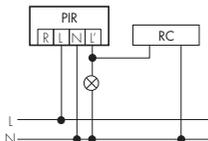
Bei Schaltung von netzparallelen Induktivitäten (Leuchtstofflampen, Schütze etc.) kann ein RC-Glied nötig sein.
