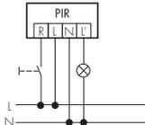
Mittels einem kurzen Tastendruck kann die Beleuchtung bei Bedarf manuell ein- bzw. ausgeschaltet werden (Achtung: Leuchtdrucktaster ohne Neutralleiteranschluss werden nicht unterstützt!).
