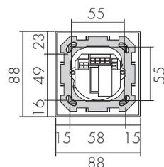
\* Schalterprogramm EDIZIOdue. Die Abmessungen variieren geringfügig je nach bevorzugtem Schalterprogramm.
