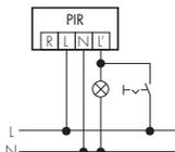
Ermöglicht das manuelle Einschalten der angeschlossenen Beleuchtung. Achtung: Licht muss wieder manuell ausgeschaltet werden.
