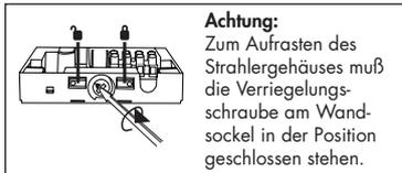
**Achtung:** Zum Aufrasten des Strahlergehäuses muß die Verriegelungsschraube am Wandsockel in der Position geschlossen stehen.
