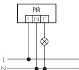
Commande d'éclairage en fonction du mouvement et de la luminosité
