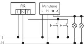
La fonction d'impulsion doit être activée.
