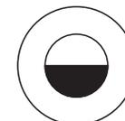
Clips de recouvrement pour couvrir la zone de détection jusqu'à 180°
