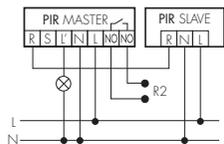
Agrandissement de la zone de détection avec un ou plusieurs appareils Slave. L'appareil Master doit toujours être monté à l'endroit où la quantité de lumière est la plus faible.
