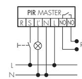
La lumière peut être allumée ou éteinte manuellement en fonction des besoins grâce à la commande à poussoir (Attention: les boutons poussoir lumineux sans neutre ne peuvent pas être gérés).
