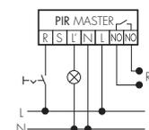
Permet l'allumage manuel de l'éclairage raccordé. Attention: la lumière doit ensuite être éteinte manuellement.
