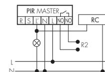
Lors du branchement d'inductances parallèles au réseau (lampes fluorescentes, contacteurs, etc.), un circuit RC peut être nécessaire.
