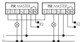
Subdivision d'une grande zone de détection en différentes zones d'éclairage avec mesure individuelle de la luminosité.
