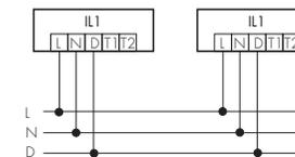
Pour la communication entre plusieurs luminaires, un seul câble de données «D» (topologie bus) suffit. La longueur maximale autorisée du câble de données «D» est de 1 km.
