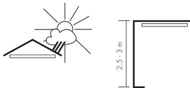
Monter si possible l'appareil dans un endroit protégé au mur à une hauteur de montage d'env. 2,5 à 3 m. Le champ doit être libre, car les rayons infrarouges ne traversent ni les objets opaques ni les vitres. (Version B avec capteur infrarouge passif).
