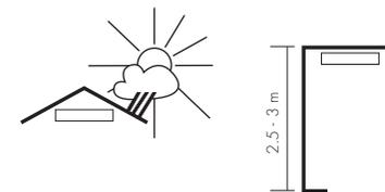
Les luminaires doivent, si possible, être montés dans un lieu protégé. S'il s'agit d'un montage mural, nous recommandons une hauteur de montage d'env. 2,5 à 3 m. Lors du choix du lieu de montage, il convient de veiller à ce que le champ soit libre car les rayons infrarouges ne passent ni à travers les objets opaques ni à travers les vitres.
