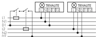
Pour la communication entre plusieurs luminaires se trouvant dans différents groupes de fusibles, le fil de données «D» doit passer par un contact auxiliaire d'un disjoncteur de puissance (LS) concerné. Ceci permet de garantir qu'aucune tension ne peut plus être appliquée après le déclenchement du disjoncteur (LS) sur le fil de données dans le groupe éteint. Si l'on utilise des disjoncteurs différentiels (FHS/FI), le fil de données «D» doit également passer par le disjoncteur FHS/FI.
