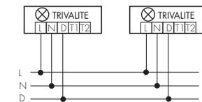
Pour la communication entre plusieurs luminaires, un seul fil de données «D» (topologie bus) suffit. La longueur maximale autorisée du fil de données «D» est de 1 km.
