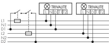
Pour la communication entre plusieurs luminaires se trouvant dans différents groupes de fusibles, le fil de données «D» doit passer par un contact auxiliaire d'un disjoncteur de puissance (LS) concerné. Ceci permet de garantir qu'aucune tension ne peut plus être appliquée après le déclenchement du disjoncteur (LS) sur le fil de données dans le groupe éteint. Si l'on utilise des disjoncteurs différentiels (FI-LS/FI), le fil de données «D» doit également passer par le disjoncteur FI-LS/FI.
