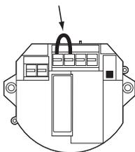
Dans certains cas rares, il se peut que l'appareil ne commence pas automatiquement le cycle de charge après le raccordement au réseau électrique, lorsque la batterie tampon est complètement déchargée (la lumière est éclairée, les LED1 & LED2 ne clignotent pas). Dans ce cas, procéder de la manière suivante:
