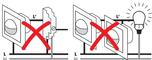
L'appareil n'est pas conçu pour être utilisé sur des minuteries d'escaliers ou des relais/contacteurs. Le fonctionnement en circuit parallèle de plusieurs détecteurs de mouvement resp. de détecteurs de mouvement et d'interrupteurs n'est pas recommandé.
