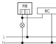
Pour fonctionner correctement, le Indoor 180 Kombi 2L nécessite une charge minimum d'env. 40 W. Pour les faibles charges ou pour la connexion des lampes PL/FL, l'utilisation d'un circuit RC peut être nécessaire.
