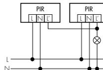
Ne jamais brancher plus de 5 détecteurs de mouvement en parallèle. En cas de nombre plus élevé, il peut se produire des commutations intempestives à cause de l'étendue respectivement de la clarté réduite de la zone de détection.
