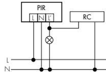
Lors du branchement d'inductances parallèles au réseau (lampes lumineuses, contacteurs, etc.), un circuit RC peut être nécessaire.
