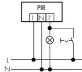
Permet l'allumage manuel de l'éclairage raccordé. Attention: la lumière doit être éteinte manuellement.
