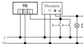
La fonction d'impulsion doit être activée.
