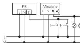
La fonction d'impulsion doit être activée.
