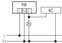
Commande d'éclairage en fonction du mouvement et de la luminosité
